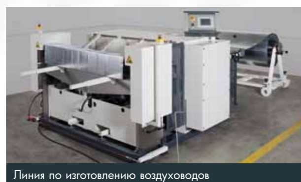
Линия по изготовлению воздуховодов
